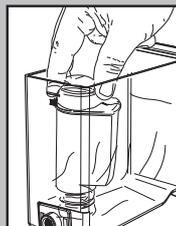
**i** Obs.: depois de terminado o ciclo de descalcificação, é possível voltar a instalar o filtro "Intenza" removido do reservatório de água no início do ciclo.
